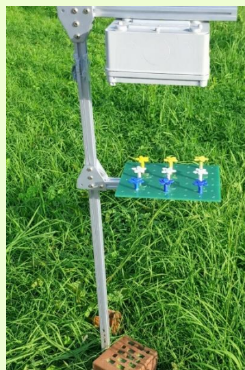
Abbildung 1: In das RoofPoll-Überwachungssystem integrierte Kamerafalle und Rechnermodul (schematische Darstellung) © Dr. Hanna Honchar
