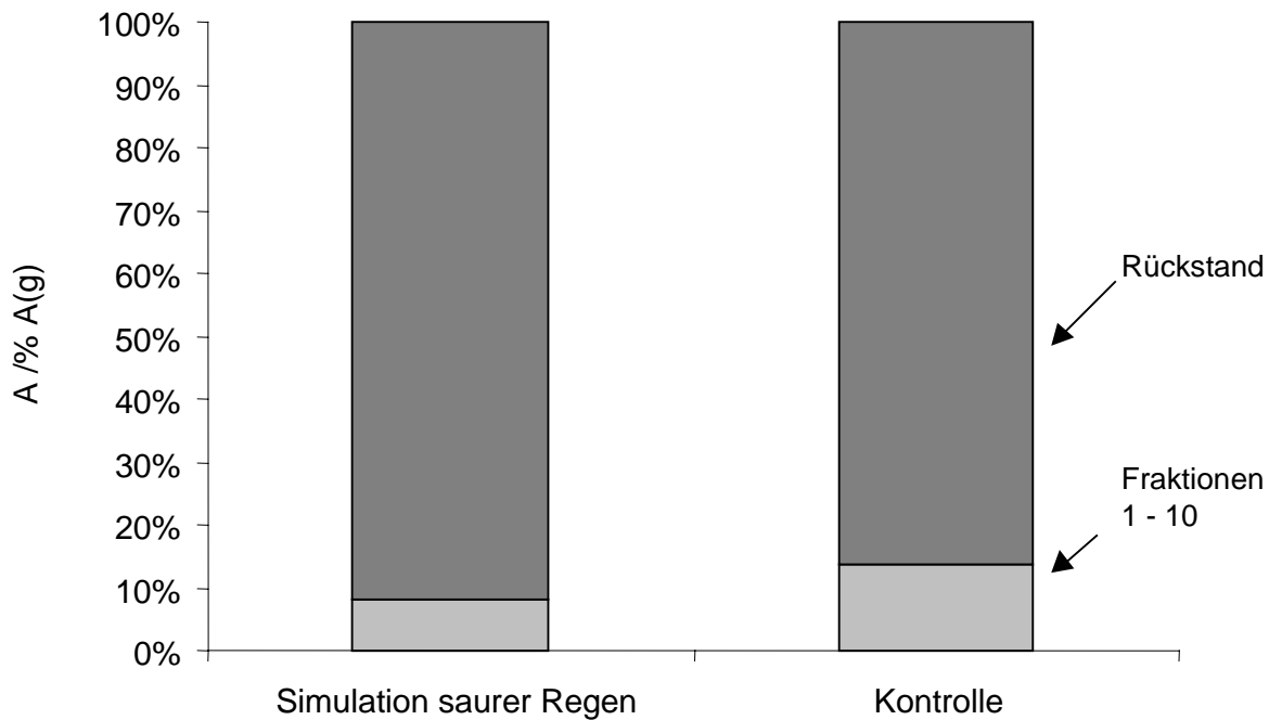
Abb. 7: Vergleich der Summe der in den Fraktionen 1-10 gefundenen Aktivitäten und der im nicht extrahierbaren Rückstand gefundenen Aktivität für die Simulation eines 1000-jährigen sauren Regens mit der Kontrolle (Extraktion mit H 2 O). Saurer Regen: Mittelwert aus drei Parallelen, Beide: Angabe Aktivität jeweils in Prozent der insgesamt in den Parallelen bzw. der Kontrolle wiedergefundenen Gesamtaktivität A(g)
