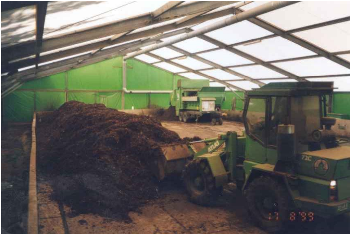
Abb. 2: On site-Behandlung von TNT kontaminiertem Boden in einer mobilen Bodenreinigungsanlage
