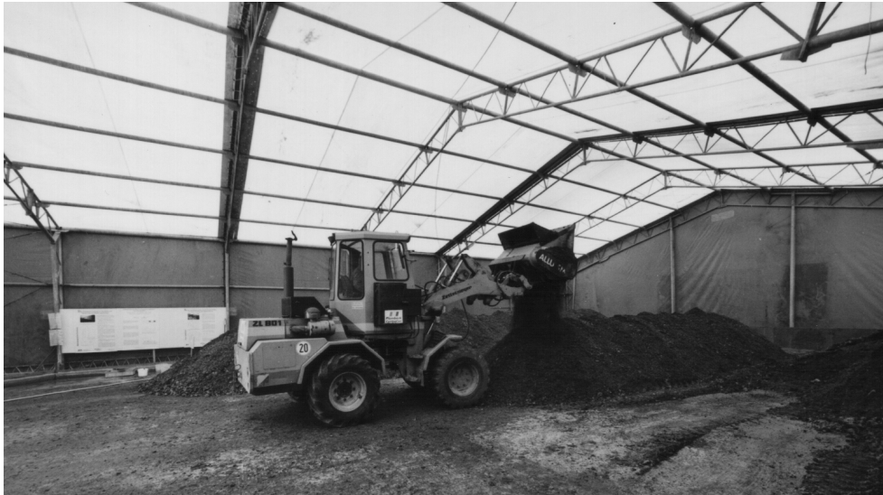
Abb. 5: Bodenbearbeitung in der Vegetationsperiode 1999 in Form von Dreiecksmieten in der Pilotanlage bei Clausthal-Zellerfeld
